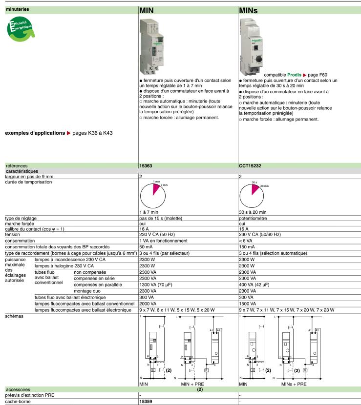
(1) Préavis d'extinction non compatible avec ce type de charge. (2) Raccordement type "3 fils".
