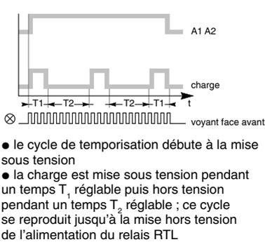
**nota** : cycle de temporisation défini suivant la position du commutateur de charge
