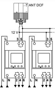
**15858** : antenne ANT DCF pour raccorder jusqu'à 5 IHP DCF sur une même antenne.
