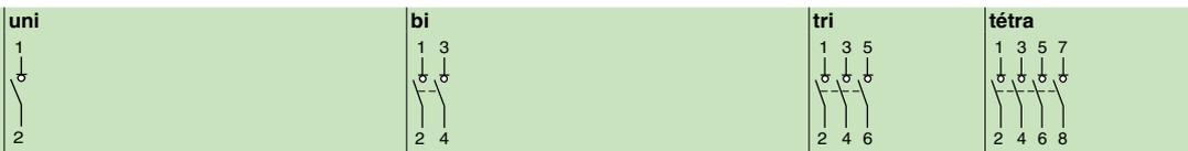
ouverture et fermeture en charge d'un circuit déjà protégé contre les surintensités et fonction sectionnement
