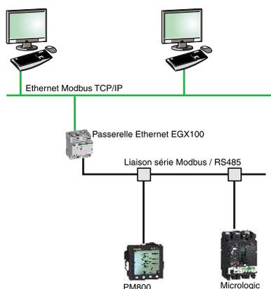
L'EGX100 sert de passerelle Ethernet pour les appareils communicant sous protocole Modbus.
