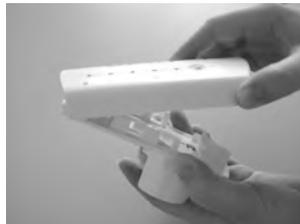
4. Présentez le socle et raccordez le Neutre (N), la Phase (L) et le Fil Pilote (FP). Dans le cas du modèle 2 zones, il faut raccorder les 2 Fils Pilotes (FPZ1 et FP Z2).
