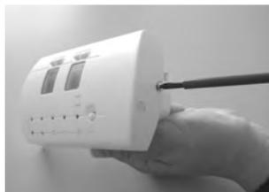
3. Insérez un tournevis à bout plat dans le talon à côté de la vis, et faites levier pour ouvrir le Boîtier Mural.
