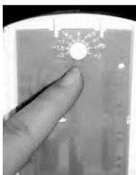
Si vous constatez un décalage entre la température affichée et votre thermomètre de référence, il est possible d'ajuster cet affichage au moyen de la molette située au dos de la façade. Pour y accéder, démontez la façade (voir page 4) et ajustez la molette d'étalonnage.
