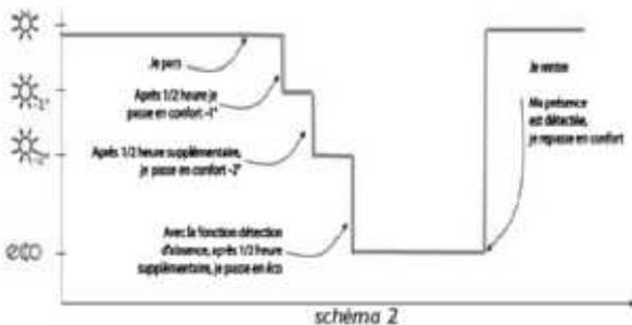
Ex. : Votre appareil est réglé à  $19^{\circ}\text{C}$ , en mode Confort (programmé ou non)
