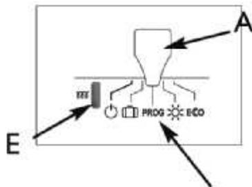
Si la température ambiante de la pièce est inférieure à celle désirée dans le mode choisi (température de Confort dans le mode Confort ☀ et température abaissée dans le mode E(☺), le voyant de chauffe E s'allume.
