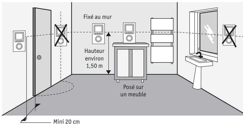
Pour un réglage optimal de la température d'ambiance, le thermostat doit être installé dans la même pièce que le ou les appareils qu'il pilote.
