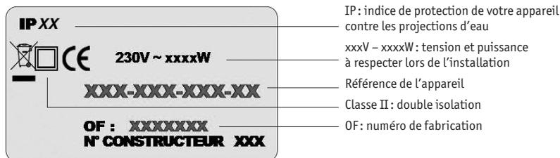
Le raccordement au réseau électrique doit être effectué en respectant :
