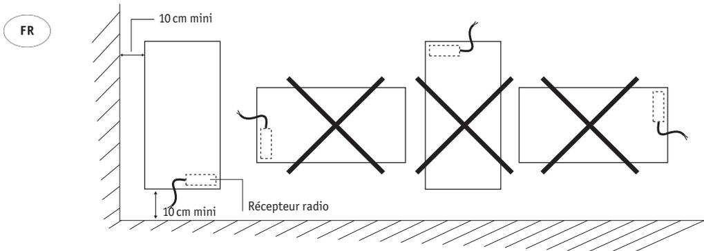
**IMPORTANT** Ce radiateur ne doit jamais être installé avec son boîtier d'alimentation en position haute. Positionner le bas du radiateur au minimum à 10 cm du sol.
